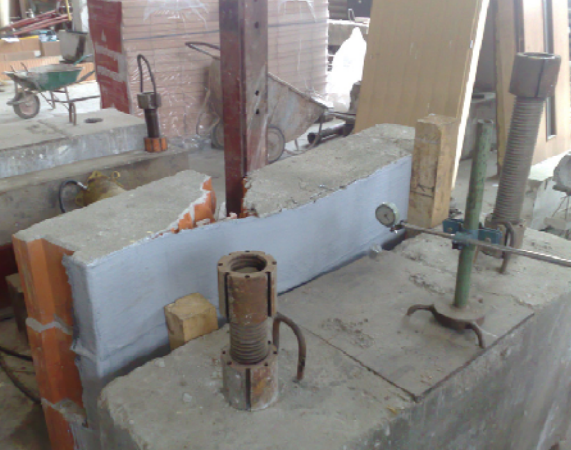
Fig. 6. Modelul M30 în timpul încercării (stânga) și după cedare (dreapta)
