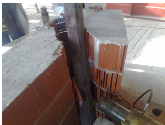
Fig. 9. Modelul M38 în timpul încercării (stânga) și după cedare (dreapta)
