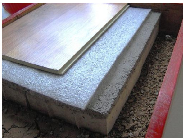
Fig. 2. Machetă reprezentând succesiunea straturilor unei pardoseli: predale cu conținut de deșeu din PVC, șapă de egalizare, parchet laminat
