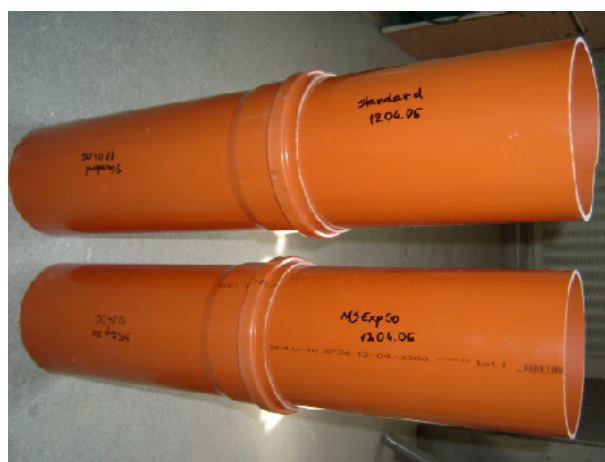
Fig.1. Țevi de canalizare: standard (sus) și obținută prin reciclarea deșeurilor (jos)
