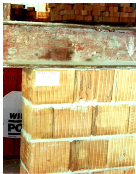
Figura 2. Încercarea la compresiune pe zidării din blocuri ceramice POROTHERM®
